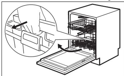
Der Korb wird automatisch auf der oberen Ebene verriegelt.
