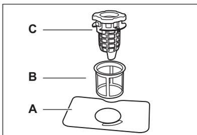
1. Drehen Sie den Ablauffilter (C) gegen den Uhrzeigersinn und heben Sie ihn an. Entfernen Sie den flachen Filter (A).
