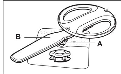
1. Drehen Sie die Anzugsmutter (A) gegen den Uhrzeigersinn und ziehen Sie den Sprüharm (B) nach oben.
