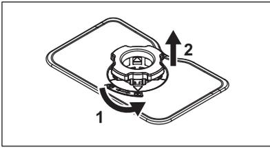
2. Drücken Sie die beiden Tasten am Ablauffilter (C) und entfernen Sie ihn vom Feinfilter (B).
