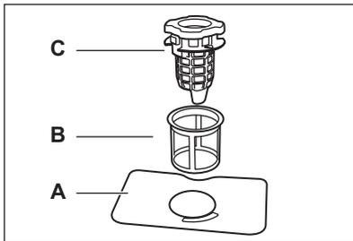
1. Drehen Sie den Ablauffilter (C) gegen den Uhrzeigersinn und heben Sie ihn an. Entfernen Sie den flachen Filter (A).
