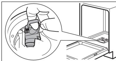
5. Entfernen Sie vorsichtig Fremdkörper aus dem Laufrad und der Umgebung.
