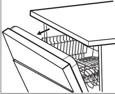
AirDry wird automatisch bei allen Programmen eingeschaltet.
